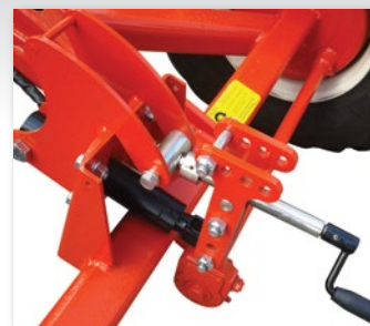
Sistem de frânare controlat hidraulic
